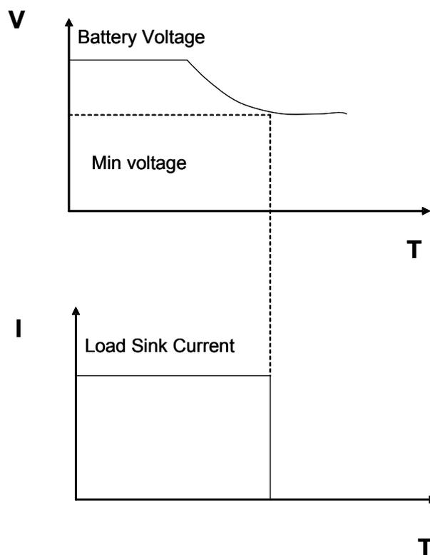
图 4-16 电池容量计算示意图
