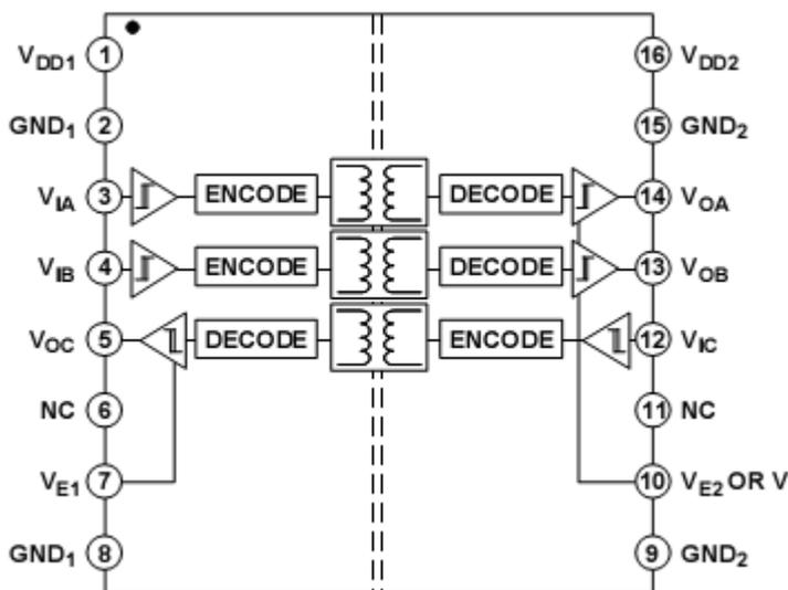
我司的通讯线 M132 的隔离原理如下：
