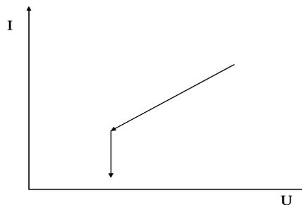
图 4.6 定电阻转换定电压模式
